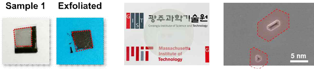
[그림2] 원격 에피택시 방법으로 성장한 질화갈륨의 박리 이미지, 실제 사용한 AIN 템플릿 웨이퍼, 그리고 AIN 템플릿 웨이퍼의 5만 배로 확대한 전자현미경 이미지. 완벽한 원격 에피택시 기술이 적용된 샘플의 경우 니켈 스트레서를 통한 박리가 제대로 이루어짐. 실제 사용한 웨이퍼의 경우 눈으로는 매우 투명하고 매끄러워 보이는 웨이퍼지만 전자현미경을 통한 확대로 관찰할 때 나노 사이즈의 핏들이 존재하며 이는 원격 에피택시 기술을 적용하는 데 장애물로 작용하게 된다. (전자현미경 이미지의 빨간 테두리 영역이 실제로 원격 에피택시 과정 중 2차원 물질이 손상되는 영역이며, 나노 핏의 9배 영역에 해당됨)
