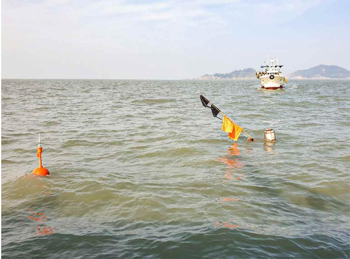
▲ 어구자동식별부이 어구 부착 및 실증시험 운용 : 연안자망에 어구자동식별 전자부이를 부착하여 어구관리 실증시험 진행
