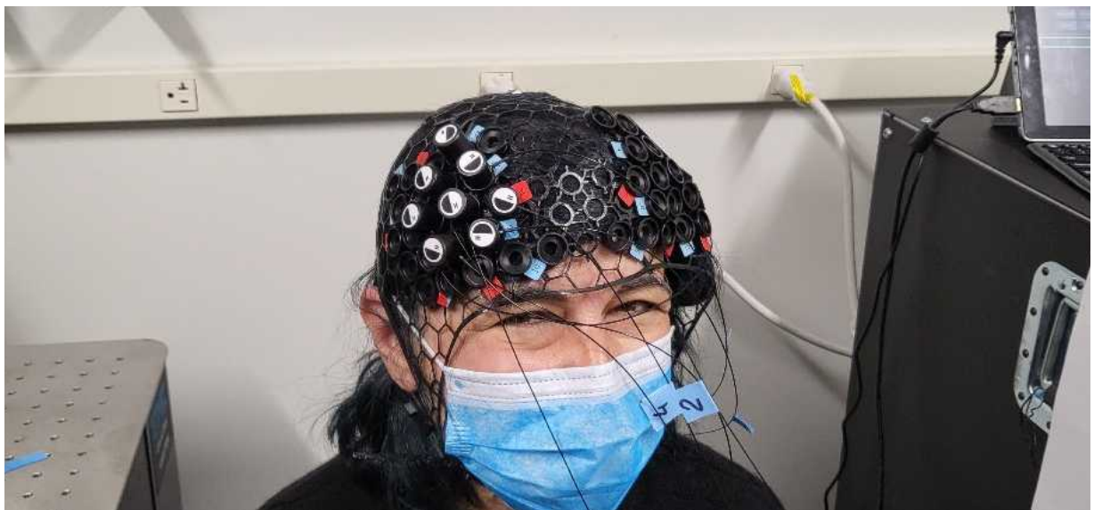
▲ 혈류 속도를 비침습적으로 측정하기 위해 광섬유 센서를 전두엽에 부착한 모습
